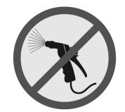
☑ WICHTIG ☑ Verwenden Sie NIEMALS einen Wasserschlauch oder jegliche andere Flüssigkeit zum Reinigen der Unterseite des Mähers. Flüssigkeiten können einzelne Komponenten des Mähers beschädigen. Verwenden Sie nur ein feuchtes Tuch zum Reinigen der Oberfläche, nachdem Sie angesammeltes Gras abgekratzt haben.
