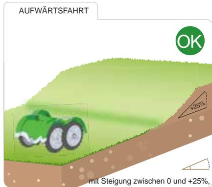
Der Roboter kann Niveauunterschiede mit einer Neigung bis 25% bewältigen, falls sie plötzlich auftreten.
