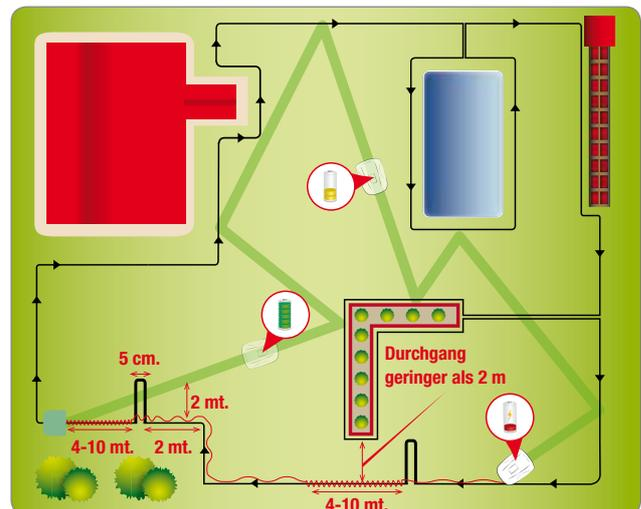
Der „Rückruf am Kabel“ zeigt dem Roboter nicht nur an, dass er sich in der Nähe der Ladestation befindet, sondern auch einen engen Durchgang oder den geraden Weg für eine rasche Rückkehr in die Ladestation.
