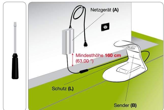
1. Installieren Sie das Netzgerät (A).
