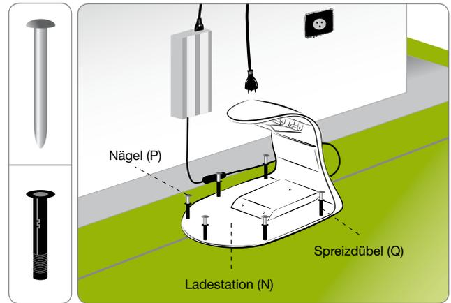
7. Schließen Sie das Netzkabel (E) der Ladestation (N) an das Netzgerät (A) an.
