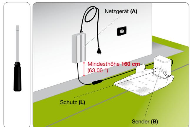
1. Installieren Sie das Netzgerät (A).
