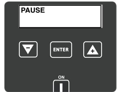
4. Gehen Sie in den Programmiermodus und wählen Sie das Menü „ARBEITSWEISE“. Wählen Sie „GESCHLOS. FLACHE“. Auf dem Display erscheint „GESCHLOS. FLACHE - 60 Min“ (voreingestellter Wert).
