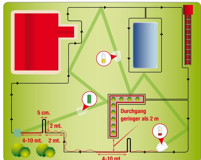
Der „Rückruf am Kabel“ zeigt dem Roboter nicht nur an, dass er sich in der Nähe der Ladestation befindet, sondern auch einen engen Durchgang oder den geraden Weg für eine rasche Rückkehr in die Ladestation. Sobald ein „Rückruf“ erkannt wird, folgt der Roboter dem Begrenzungskabel mit geringer Geschwindigkeit und mit größerer Präzision etwa 10 m (33') weit, um dann wieder zum Rückkehrmodus „V-Meter“ zurückzukehren, falls er nicht auf die Ladestation oder die schnelle Rückkehr trifft.
