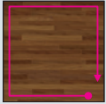
1 Stufe Der Mamirobot fährt möglichst nahe an eine Wand und folgt dieser dann.
