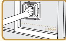
3. Setzen Sie den Winbot in einem Abstand von ca. 10 cm (4 inch) oberhalb und horizontal von den unteren Ecken des Fensters auf.
