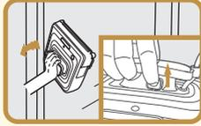
2. Zum Abnehmen des Winbot fassen Sie die Einheit am Handgriff und stellen Sie den Schalter auf der Unterseite des Handgriffs auf OFF. Halten Sie den Handgriff weiter fest, heben Sie mit einem Finger das Luftablassventil an und nehmen Sie dann die Einheit von der Fensterfläche ab, wenn die Saugkraft abgenommen hat.
